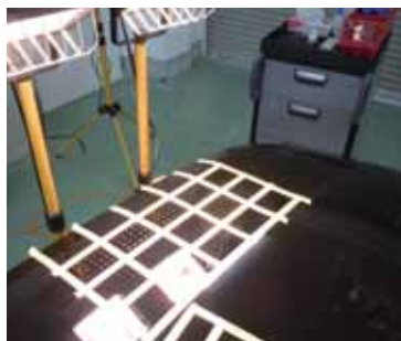
クリスタルキーパーを施工した塗装と、何もコーティングしていない塗装の両方に、テスト材料を一滴ずつ点に塗布しテストを行った
