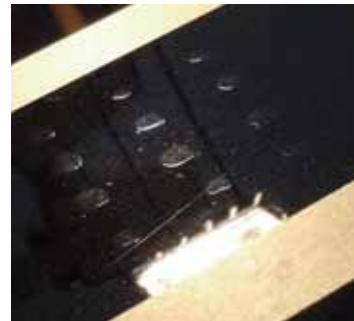
ブレーキフルードを塗布して、数時間放置した塗装面。塗装が膨らんで「膨潤」状態になっている
