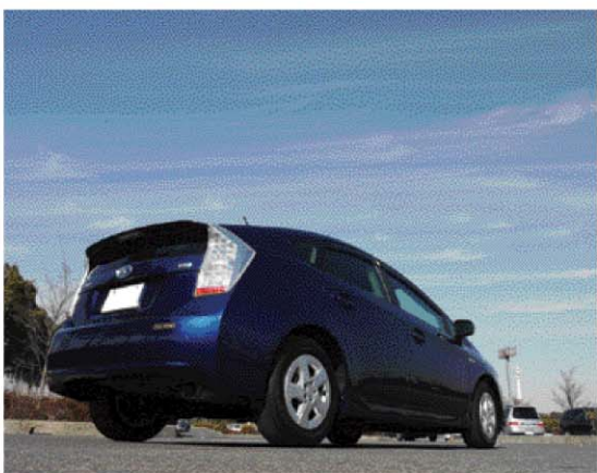
劣化した塗装が粉化したボディ。触ると分解された塗装の成分である樹脂や顔料が指などにつついてしまいます。こうなると磨いてもツヤは戻りません。
