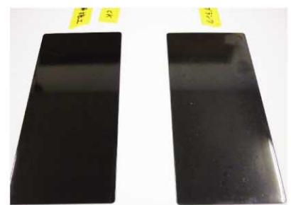
クリスタルキーパーを施工した塗装板と何もしていない塗装板 クリスタルキーパーを施工した塗装板と何もしていない塗装板に約3年分に相当する紫外線を照射(300時間)。クリスタルキーパーよりも塗装のままの方が劣化していることが目視で確認できる。
