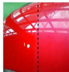
一部にカバーをかけて、劣化の姿を比較。カバーをした方の塗装（左半分）にはツヤは残っているのに、カバーしていない方（右半分）は完全にツヤびけし、白ぼけてしましました。これも、磨いてツヤを再生するの難しいでしょう。
